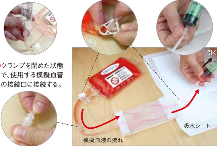
【使用上の注意】①使用中は常に模擬血液バッグと本体のクランプは開放したままにしてください。閉じたままシリンジから空気や模擬血液を注入すると液漏れや模擬血管が破裂する恐れがあります。
